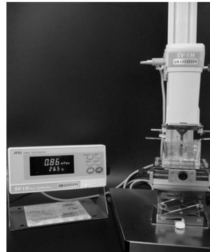
図2. 音叉振動式粘度計 SV-1A (サンプル容量2mlから測定が可能)
