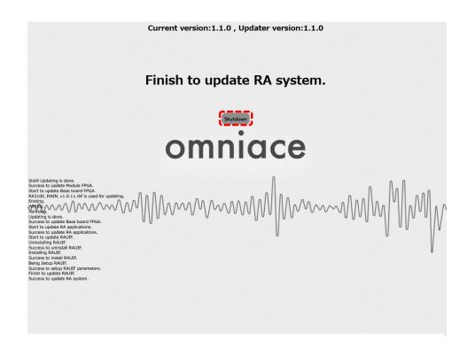
13. 再び、RA3100 の電源を投入し、6. 7. を実行し、ソフトウェアのバージョンが、ダウンロードしたファイルバージョン x.x.x と同じことが確認できればバージョンアップは完了となります。
