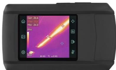
➤ 熱画像解像度アップ（Super IR 時に 240×240 ピクセル）
