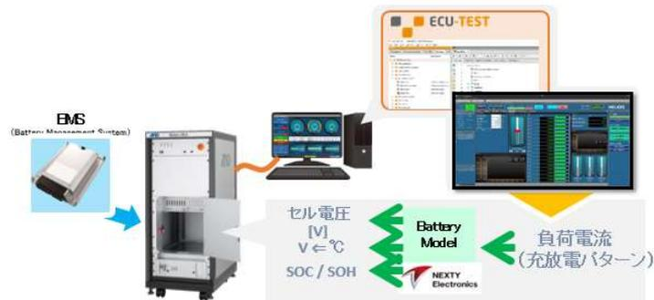
(2) 交流重量法に対応したバッテリーエミュレータ（バッテリー内部インピーダンス模擬装置）
