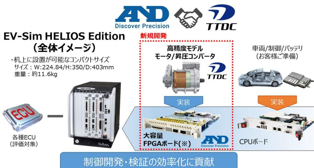
※FPGA : Field Programmable Gate Array の略で、何度でも書き換えられるデジタル回路の電子部品
