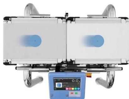
従来機に比べて風や振動の影響を受けにくい設計へと進化し、耐環境性能が大幅に向上しました。最新 CPU の搭載により処理能力が向上し、新たに実装した振動除去フィルタ HPDF（High Performance Digital Filter）を最適化したことにより、高速域での精度が最大 80%向上しました。従来に比べ、重量選別工程の高速化が可能となり、生産能力・生産効率の向上に貢献します。
