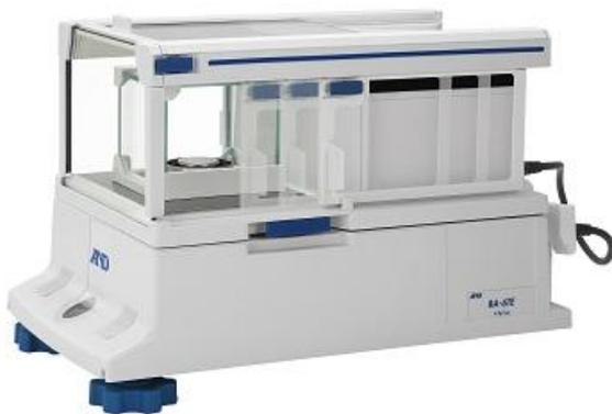
オートドアを最適な開閉幅に設定することにより、外乱要因（風や温度変化）の影響を最小限に抑え、高精度な計量を実現いたします。
