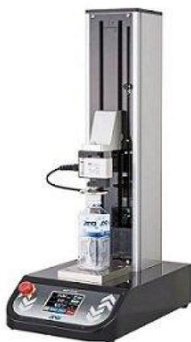
A & Dは、各種の万能試験機（引張・圧縮試験機）をご用意しています。
