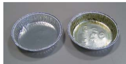
専用のアルミ製容器 右が乾燥後に残ったオイル
