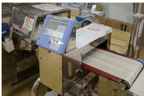
2016年に導入していただいた金属検出機「AD-4971E-3510」(脱酸素剤対応ソフト付き)
