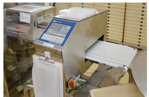
A&D製金属検出機「AD-4976E-H3510」 (脱酸素剤対応ソフト付き)
