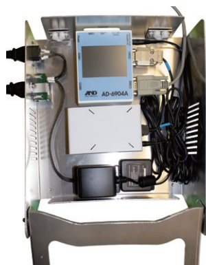
A&D製データ収集アダプタ「AD-6904A」を活用した「インテリジェント・トレイ」
