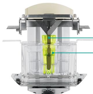
チタン製(振動子&温度センサー)
