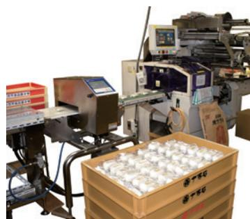
金属異物検査と鉄系脱酸素剤の欠品検査が1ラインで同時に行える、A&Dのオリジナル技術
