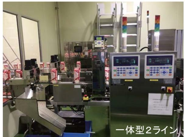
大西様：ラインオペレーターが充填管理システムに登録した生産アイテムを選択することで、各設備に自動で品種情報が転送されて品種切り替えを行っています。この自動システムもA & Dさんの製品の通信機能を有効に活用することで成り立っていて、ラインオペレーターの設定ミス防止に大変役立っています。
