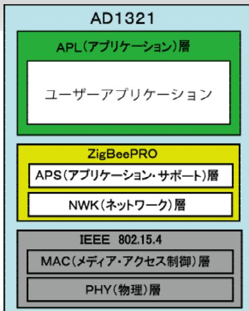
IEEE 802.15.4ベースにユーザー様が独自の通信プロトコルを作成する場合。ZigBeePRO以外のプロトコルを使用する場合はこれに該当します。
