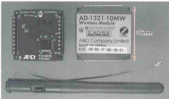
〈写真1〉 ZigBeePRO モジュール AD1321-10MW (出力 10 mW) と汎用アンテナ (ゲイン 2 dBi)
