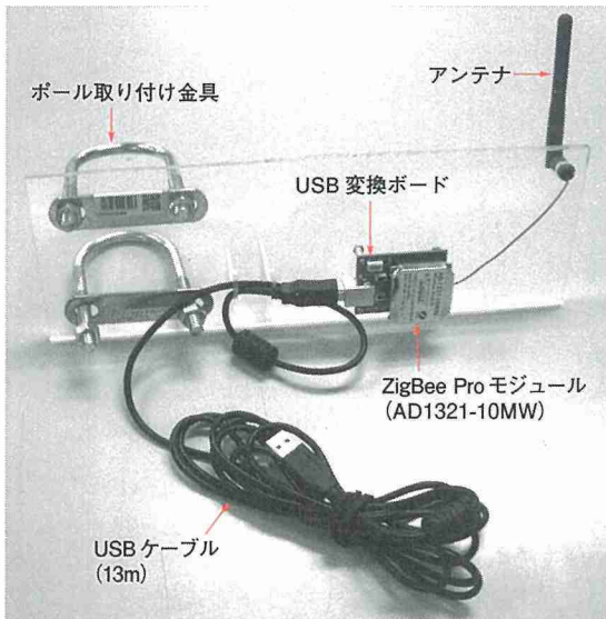
〈写真2〉アクリル板にZigBeePROモジュールやアンテナを配置してポールへ取り付けける
