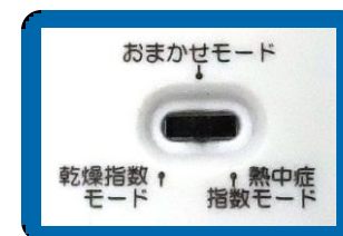
モード切替スイッチ (裏面) (AD-5687 の例)
