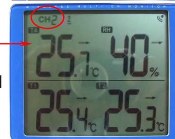
図4. 子機（外部センサー）のチャンネル番号の設定
