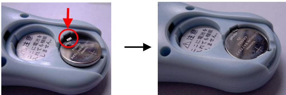
電池カバーを元通りに取り付ければ、電池交換が完了です。
