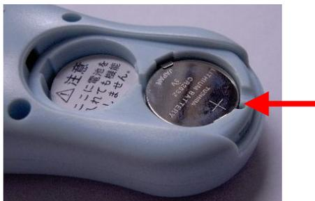
上の写真の赤い矢印の所に先端の細いものを差し込み、古い電池を外します。
