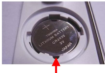
上の写真の赤い矢印の所に先端の細いものを差し込み、古い電池を外します。
