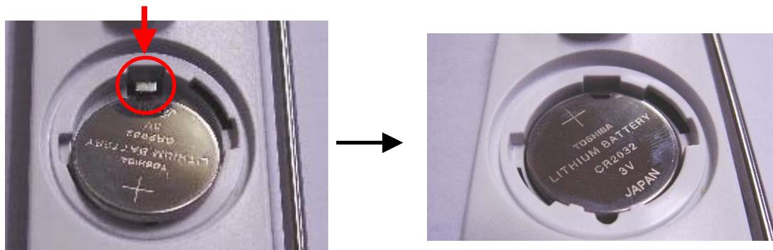
電池カバーを元通りに取り付ければ、電池交換が完了です。
