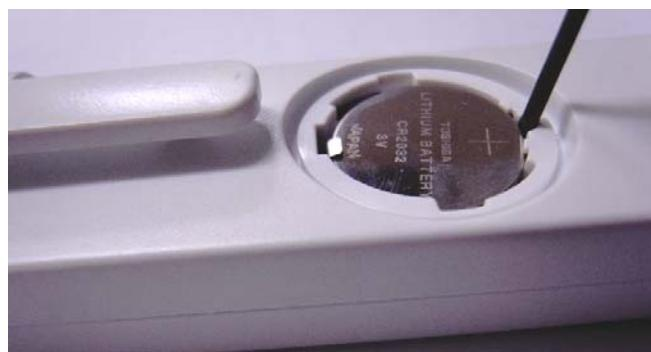
下の写真の赤い丸で囲んだ部分(金属の端子)が上になるように電池を入れます。
