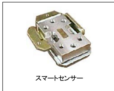
金属の塊にゲージを貼っただけでは、歪量が少なすぎる。従って、金属が適度にひずむように加工する(これをきわい体と呼ぶ)。
