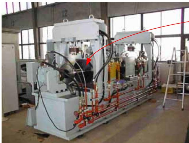
供試体に加える加速度を実路走行の加速度波形になるよう再現して、繰り返し加振したい
