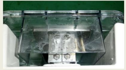
アルミ製センサ（ロードセル）部も全く問題なし。他のSUS製固定ネジ類も錆は見当たりません。ロードセル上面には塩の結晶が残る程。過酷な試験条件だった事が伺えます。
