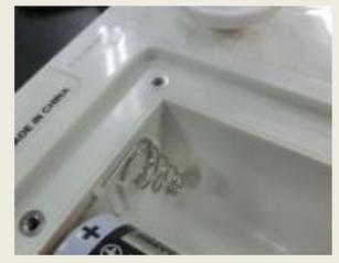
8個のネジでがっちり密閉されている電池蓋の内部には水の浸入もなかったため、金具類も錆びていません。
