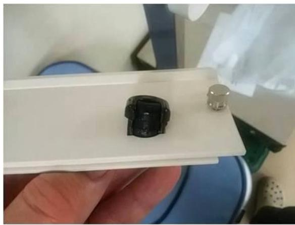
③ ケーブルクランプを取り外した穴に、ロードセルケーブルを通します
