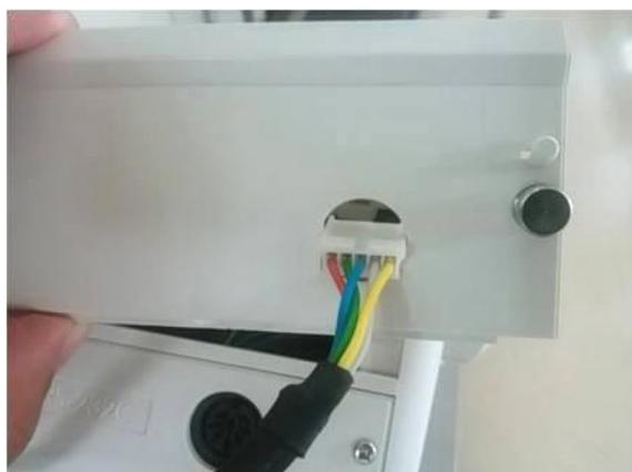
④ 取り外したケーブルクランプを広げ、ロードセルケーブルを通します
