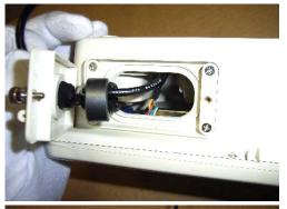
余分なロードセルケーブルを "インジケータ" 内部へ収 納し、"キャルパネル" をしめます
