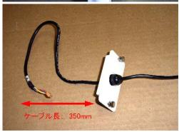
10 <u>"ケーブルクランプ"をロードセルケーブルへ巻きつけて</u> "キャルパネル" に取付けます
