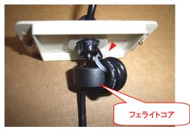
**6** ロードセルケーブルを固定している "結束バンド"を <u>ニッパーで切断し、"フェライトコア"を取り外します</u>
