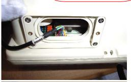
(12) ロードセルケーブル先端のコネクタを接続します。
