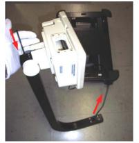
**8** "ポール" からロードセルケーブルを引き抜きます
