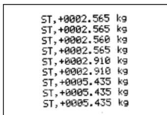
2.565kgの時に、上記印字例のように“ST,+0002.565 kg” と印字されます
