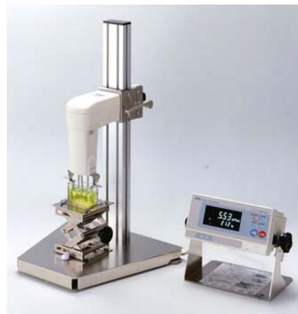
写真1. 音叉形振動式粘度計
