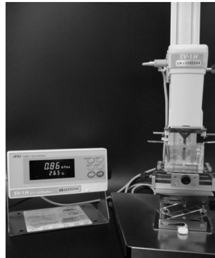
図2. 音叉振動式粘度計 SV-1A
