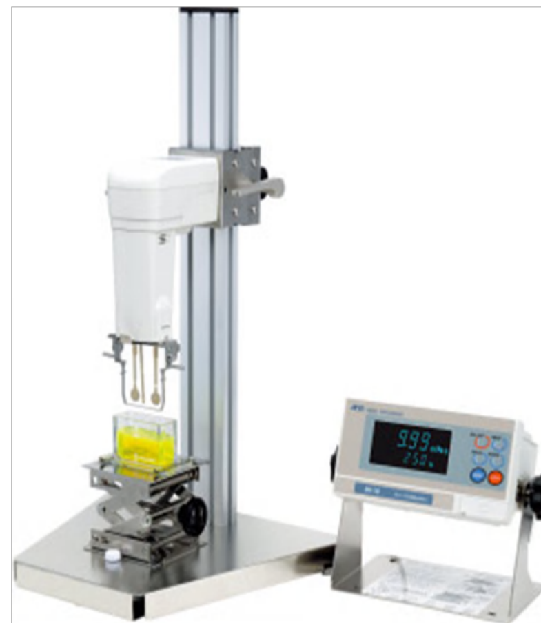
音叉型振動式粘度計 SV-10 (株) エー・アンド・デイ
