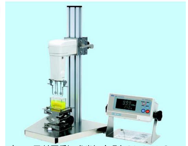
音叉型振動式粘度計SV-10
