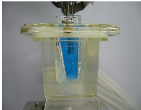
Fig. 6 側面写真 : 中央部に温度計と振動子
