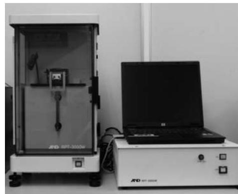
写真-1 剛体振り子型物性試験機
