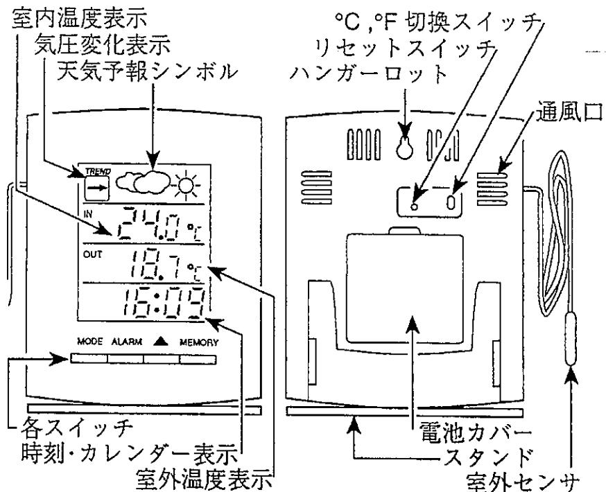
電源が入り最初に出てきた表示のほか付加機能の表示があります。温度表示は室内と室外温度を表示します。時刻表示は現在時刻に加えて、アラームとカレンダを表示します。付加機能を使うには、「MODE」「ALARM」「MEMORY」のいずれかのスイッチを押してください。
