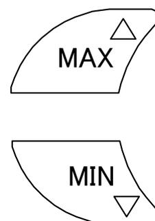
アラーム設定値をクリアする場合は、[MAX/△]ボタンと[MIN/▽]ボタンを同時に押してください。表示が「— — %」に戻り、アラーム設定値がクリアされます。
