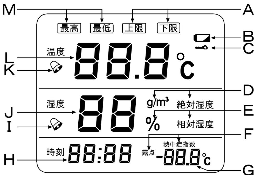
**A:** 温度と相対湿度のアラーム設定時に表示されます。上限アラーム設定時に「上限」が点灯し、下限アラーム設定時に「下限」が点灯します。
