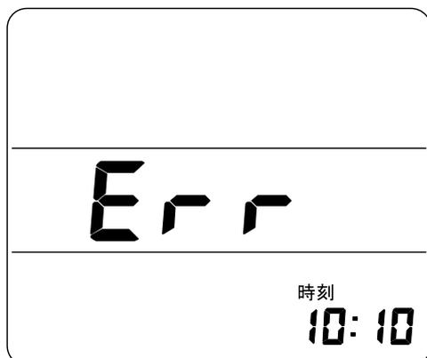
温湿度センサに異常が発生すると、左図のように表示されます。この表示が出た場合は、温湿度センサの破損の恐れがあります。
