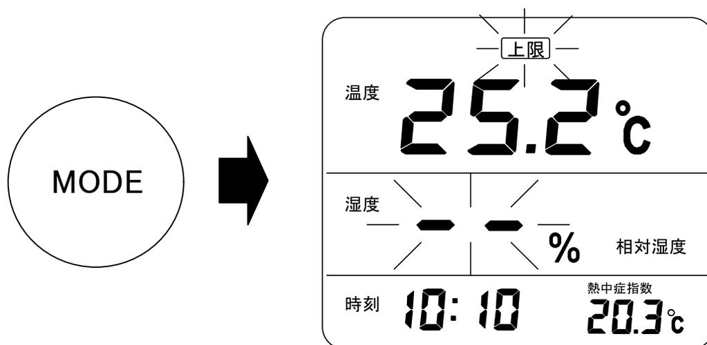
[MAX/△]ボタンか[MIN/▽]ボタンを押して、相対湿度の上限アラームの設定をします。[MAX/△]ボタンを押すと設定値が増加し、[MIN/▽]ボタンを押すと設定値が減少します。また、ボタンを押し続けると、数字が早く変わります。
