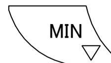
また、ボタンを押し続けると、数字が早く変わります。アラーム設定値をクリアする場合は、[MAX/△]ボタンと[MIN/▽]ボタンを同時に押してください。表示が「—.— °C」に戻り、アラーム設定値がクリアされます。
