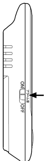
本体左側のアラーム音ON/OFFスイッチを「OFF」に切り替える事により、ボタン操作時やアラーム動作時のブザー音を鳴らないようにすることができます。スイッチを上側に切り替えるとブザーオン、下側に切り替えるとブザーオフになります。
