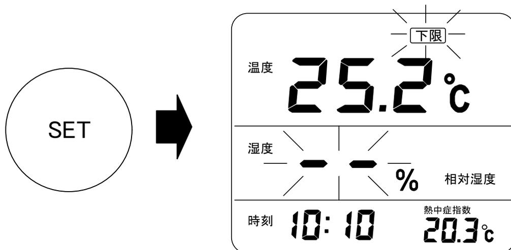
[MAX/△]ボタンか[MIN/▽]ボタンを押して、相対湿度の下限アラームの設定をします。[MAX/△]ボタンを押すと設定値が増加し、[MIN/▽]ボタンを押すと設定値が減少します。また、ボタンを押し続けると、数字が早く変わります。
