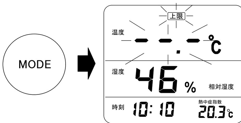
[MAX/△]ボタンか[MIN/▽]ボタンを押して、温度の上限アラームの設定をします。
