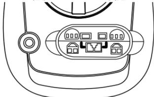
2. 下図のコネクタ部にコンデンサの両端を挿入して、内部金属部に接触させると、表示部に測定値が表示されます。
