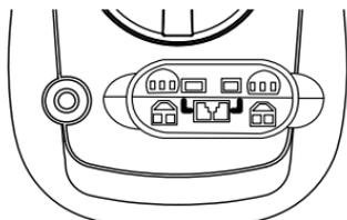
2. 下図のコネクタ部に抵抗の両端を挿入して、内部金属部に接触させると、表示部に測定値が表示されます。
