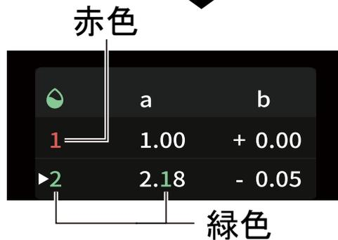
手順 5. 手順 4 を繰り返し、傾き **a** の最下位の数字まで設定します。設定が終了すると、加減 **b** の符号が緑色に表示されます。 **Zero** ボタンを押す毎に「+」と「-」を切り替えることができます。
