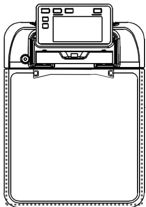
体重測定中に、点線部の外の支柱、測定バー、表示器等に触れると、測定誤差の原因になります。
