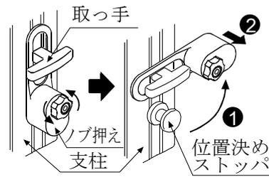
2. 支柱後部の②位置決めストッパが移動用ロック位置 (または各レンジマークのロック位置)で固定されていることを確認します。
