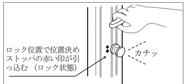
6. ノブ押えを位置決めストッパに被せて、ノブ押えのネジでしっかり固定してください。
