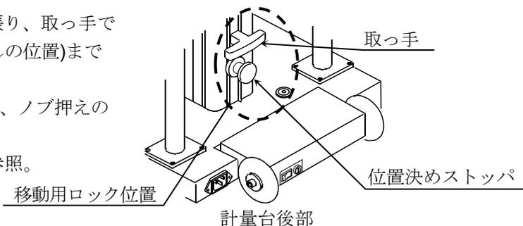
3. 計量台後部にキャストが付いていますので、本機の後ろ側から手すりを持って、本機を手前(右図参照)に傾けてください。
