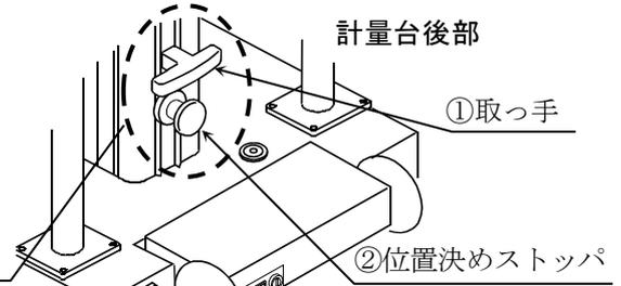
3. 片手で①取っ手を握りしっかりと支えながら、もう片方の手で②位置決めストッパをつかみ、根元の赤い印まで引き出すとロックが外れ支柱が可動状態になります。そのまま、上下いずれかの方向にスライドさせロック位置からずらして②位置決めストッパから手を離します。
