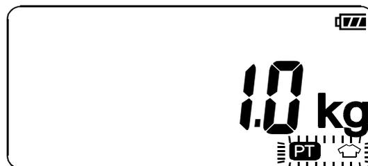
または、**車いす引** スイッチを押すと初期の車いす引き量“10.0 kg”が表示され、「PT」マークと「車いす」マークが点滅します。
