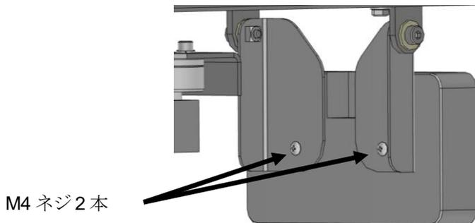
3. 付属の板金を挟んで、表示器を再び M4 のネジで取り付けてください
