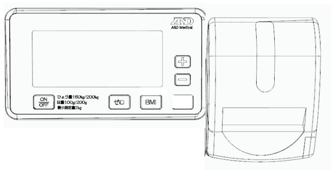
5. 付属の通信ケーブル 1K03937 をプリンタと表示器の通信コネクタに取り付けます。
