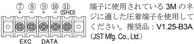
端子に使用されている 3M のネジに適した圧着端子を使用してください。推奨品 : V1.25-B3A (JST Mfg. Co., Ltd.)
