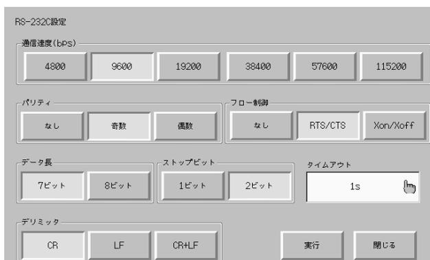
通信速度、データビット、ストップビット、パリティ、フロー制御、デリミタを設定します。
