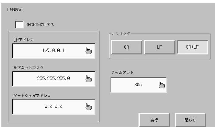
IPアドレス、サブネットマスク、ゲートウェイアドレス、デリミット、タイムアウトを設定します。キーを押すと設定ウィンドウが開きます。
