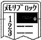
— データNo.</p> | <p>測定データの書き込みまたは読み出しを行うメモリーブロックを指定します。</p> <p>データNo. 部には以下のような表示を行います。</p> <p>&lt;データNo. 部の右側に*マーク表示&gt;</p> <p>* ..... 測定データを書き込むメモリーブロック</p> <p>&lt;データNo. 部が反転表示&gt;</p> <p>■■■■ .. 測定データを読み出すメモリーブロック</p> <p>設定キを押してカーソルを表示し、任意のメモリーブロックに*マークと反転表示を移動し（同時に移動します）、再度設定キを押します。</p>                                                                                                                             |    |    |     |     |     |     |     |    |   |   |   |    |    |    |     |    |
