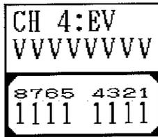
← チャンネルNo.とアンプの種類(EV:イベントアンプ), 入力形式(V:電圧入力,C:接点入力)を表示します。
