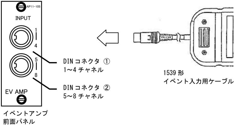
イベント用フローティング電圧プローブ (1539 形) の電圧測定ケーブルは電源ラインに、イベント入力ケーブルはイベントアンプユニットに接続します。
