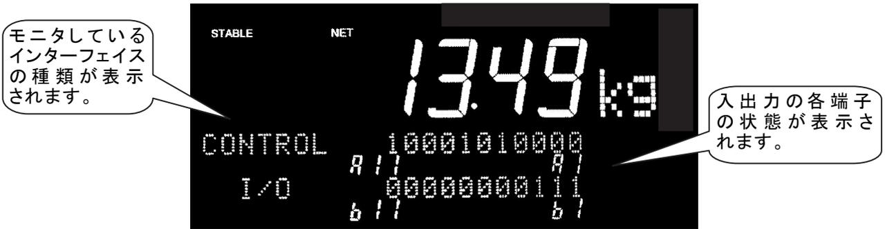
図 69 モニタモードの表示例(コントロール I/O)
