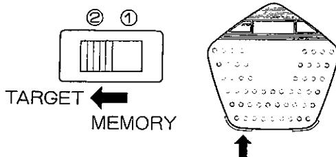
②電源が切れていることを確認してから、メモリ／ターゲットスイッチを押し続けます。
