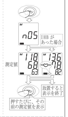
メモリをすべて消去したい場合 5秒以上連続して[メモリ]ボタンを 押し続けると"**M**"マークが点滅して メモリをすべて消去します。
