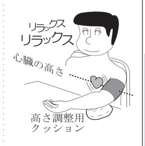
3. リラックスして、[開始/終了]ボタンを一度押してください。電源が入り、自動的に加圧を開始し、測定を行います。測定中に加圧の不足を検出すると、最高2回まで自動的に再加圧を行います。
