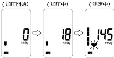
6. 測定が終了すると測定結果と血圧レベル(※1)を表示し自動的にカフに残っている空気を排気します。測定中に不規則な脈が含まれていた場合 I H B マーク「♡」(※2)を表示します。
