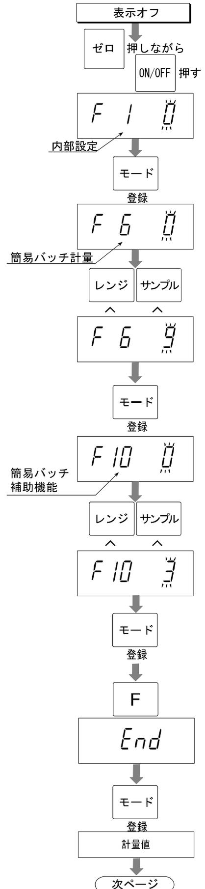
ステップ 8 **モード** スイッチを順に押してHIが点滅する「定量」の設定表示にしてください。
