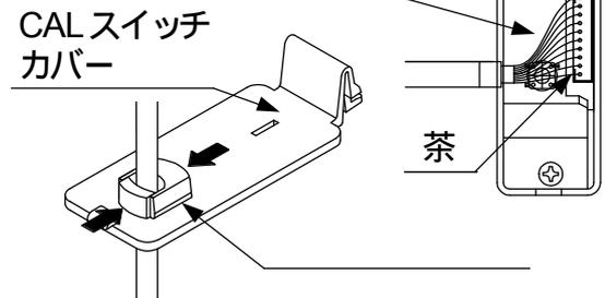
7. 図のように表示固定板をもとの位置からずらし、ステップ2ではずした M6 ネジ4本を使って固定します。M4 ネジは使う必要ありません。
