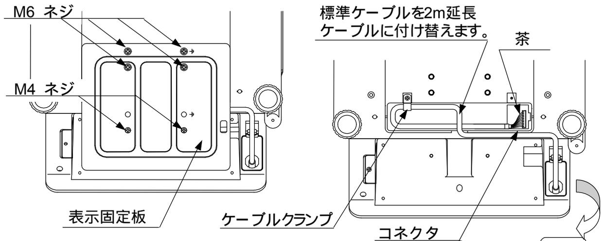
3. ケーブルクランプを留めているネジを取り、標準ケーブルのコネクタを抜きます。また、CAL スイッチカバーを開けコネクタを抜きます。
